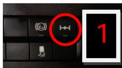
1 Differentialsperre Quer Hinterachse
