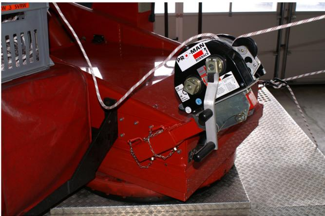
Die Rettungswinde an der Autodrehleiter ADL G4 montiert
