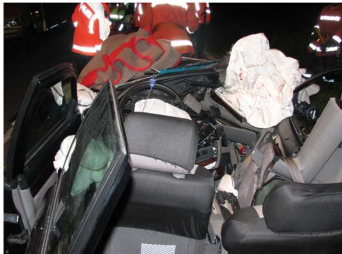
**Gut zu erkennen, die stark deformierte Beifahrerseite.**
