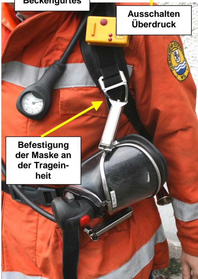
Befestigung der Maske an der Trageinheit
