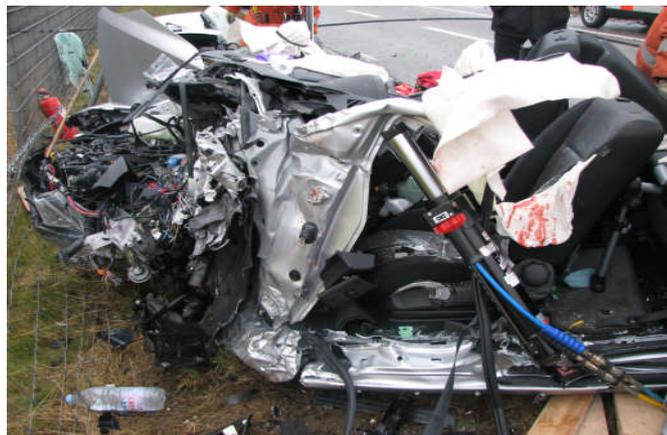
**Der Einsatz des Hydraulikzylinders an der A-Säule.**
