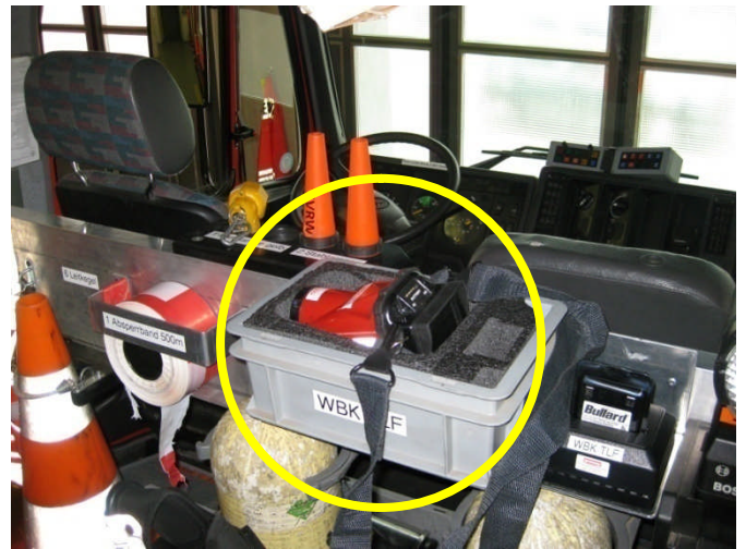
Die WBK ist neben den Funkgeräten stationiert.
