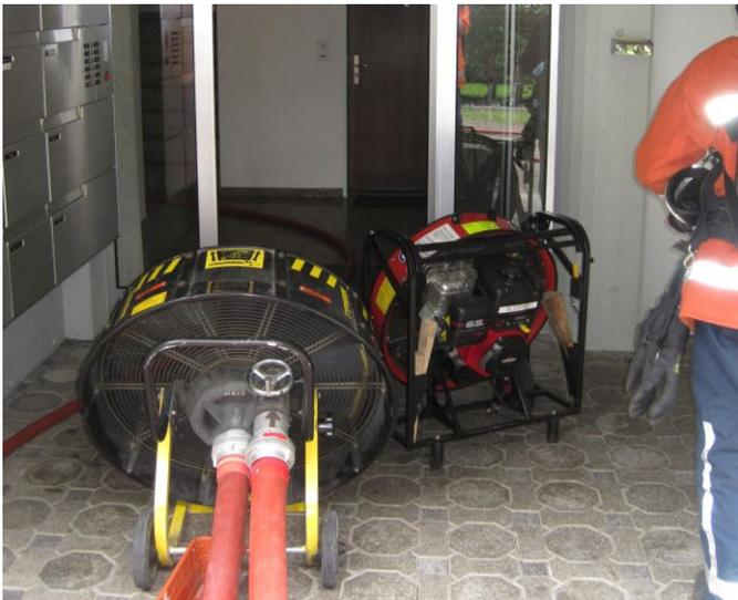
**Zur Entrauchung werden zwei Lüfter eingesetzt**
