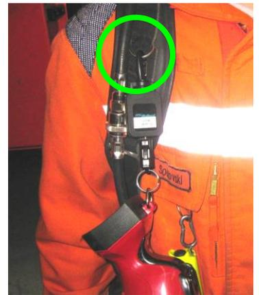
Die Kamera wird am AS-Gerät befestigt
